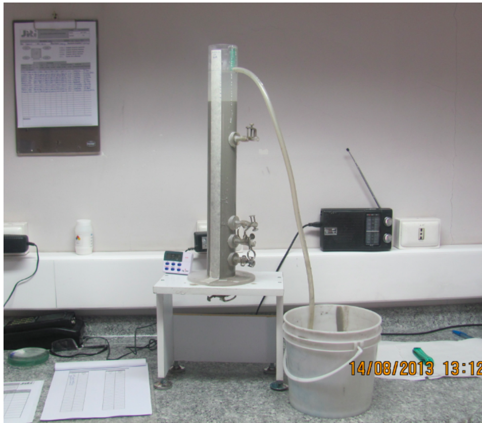
Figura 4.4: Columna de acrílico en proceso de sedimentación batch posterior al experimento continuo.
