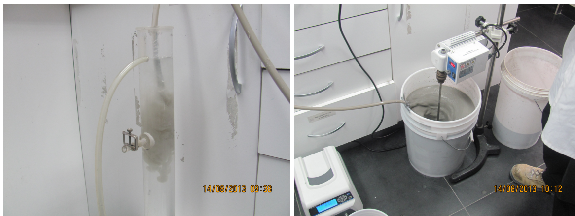
(a) Inicio de un experimento continuo. Columna inicialmente llena de agua clara.
