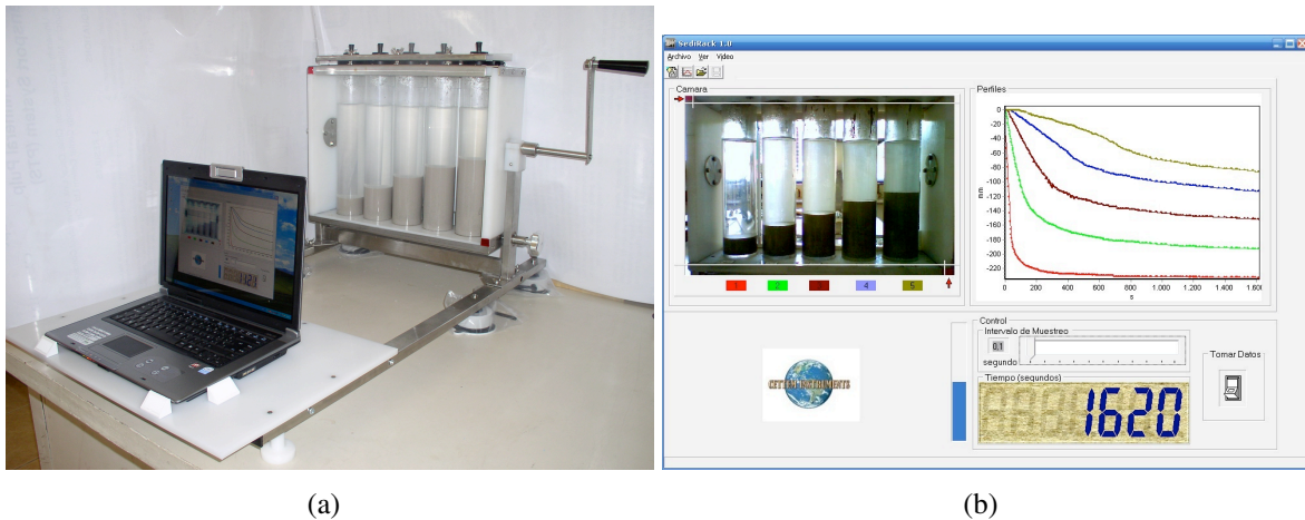
Figura 3.1: (a) Equipo de SediRack. (b) Captura de pantalla del software propio con interfaces suspensión-agua medidas por SediRack.
