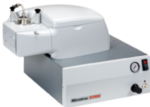
Figura 4.3: Microtrac. Equipo para medir el tamaño de las partículas usando un arreglo de tres lasers para ello.
