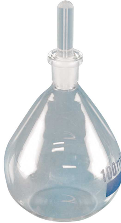
Figura 3.3: Picnómetro de 100mL de volumen bajo estándar ASTM D-854
